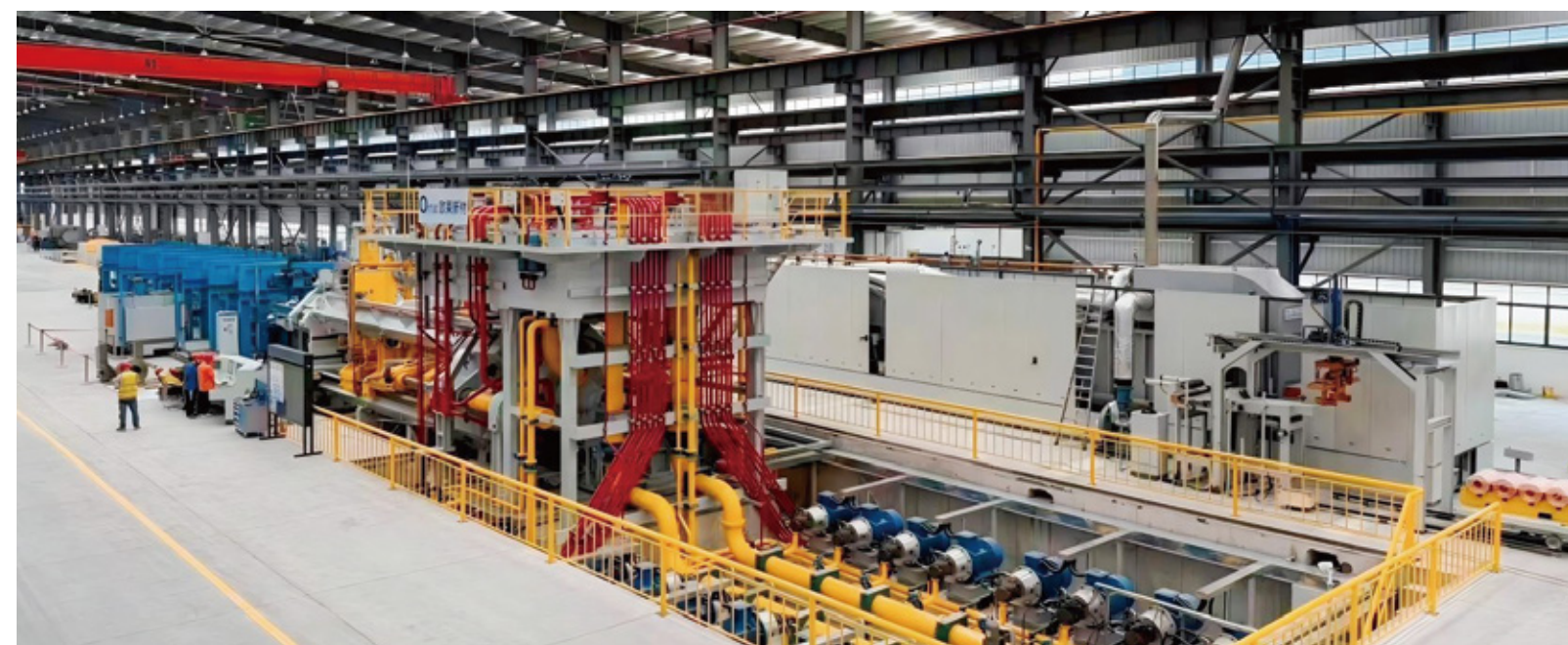
5500吨双动铜挤压机--国内同行业最大双动铜挤压机之一
